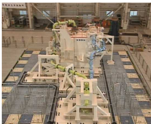
図 3-4 BWR-FDW の実証試験体 (参考文献 3-2 より引用)
