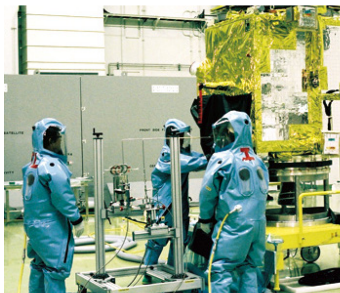
図 1.3.1：宇宙機への推薬充填の様子（スケープスーツ着用）
