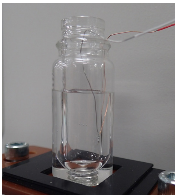
図 3.3.2 : 推薬温度影響評価試験時の滴下受け側（調温側）の試験管の外観
