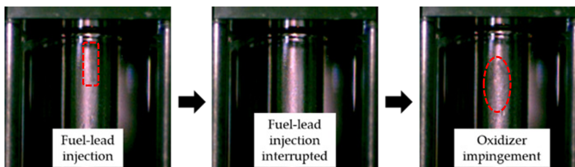
図 4.2.12 : 燃料リード噴射のガス噛みの様子
