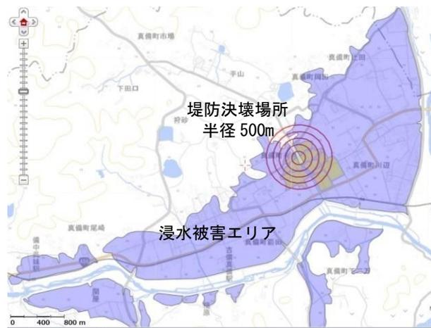
図 2-2-4-10 浸水被害エリアと堤防決壊場所
