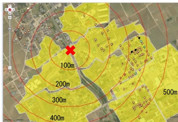
図 2-2-4-13 末政川の堤防決壊場所からの距離と土砂堆積エリア判読（黄色）
