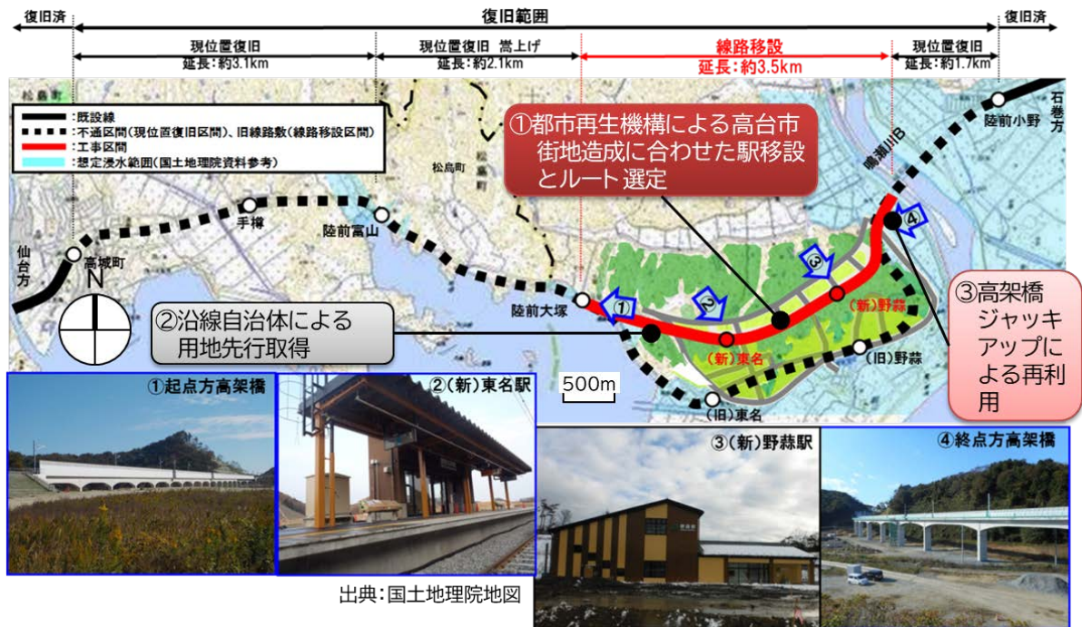
図 4-12 仙石線移設復旧(陸前大塚～陸前小野間 4.7km)
