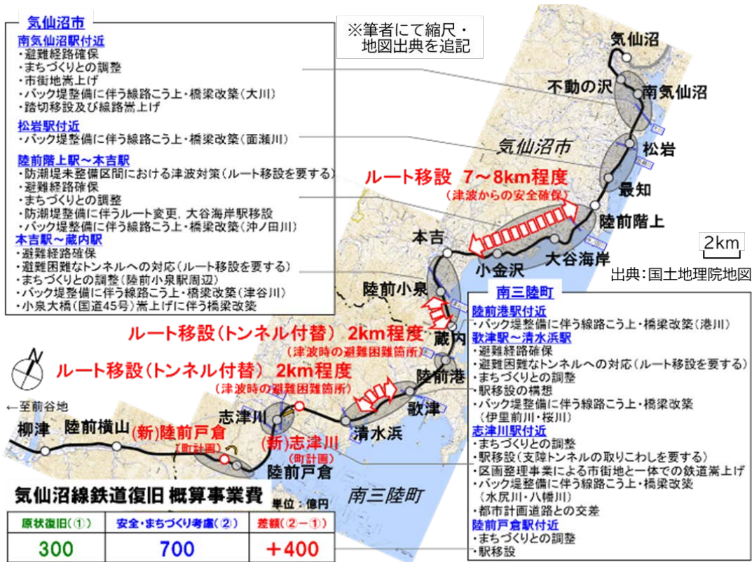
図 4-8 気仙沼線鉄道復旧の課題と復旧費用の例(復興調整会議事業者提出資料)
