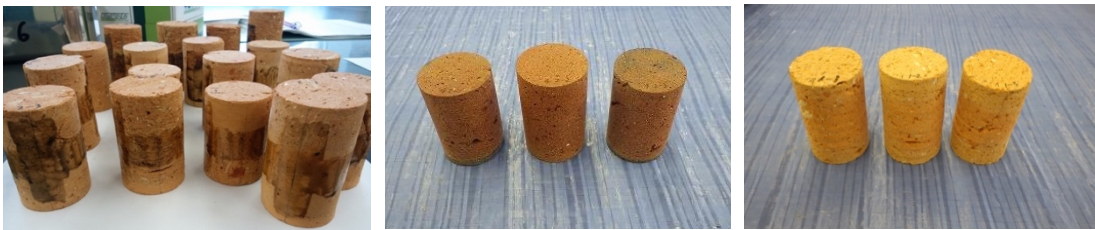
図 2.4 加工後の試験体 (左 : 東洋組煉瓦、中 : 小菅集治監製煉瓦、右 : 添川瓦工場窯跡出土の煉瓦)
