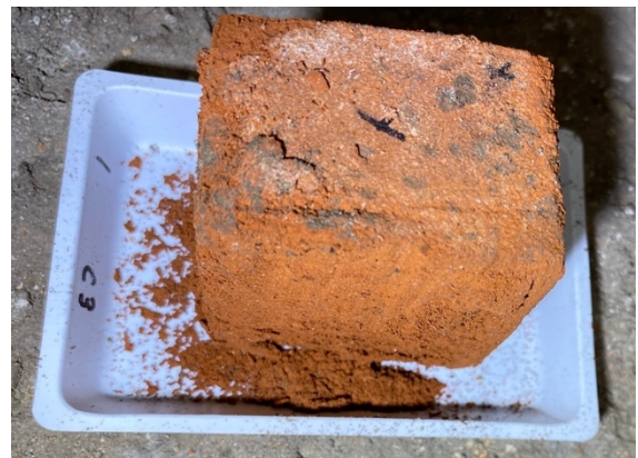
図 3.12 1mol/L の \text{Na}_2\text{SO}_4 水溶液で作成した煉瓦試験体に見られた崩壊
