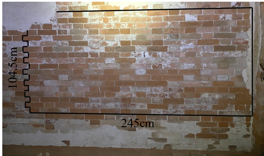
図 3.18 煉瓦壁面の水分率の測定範囲
