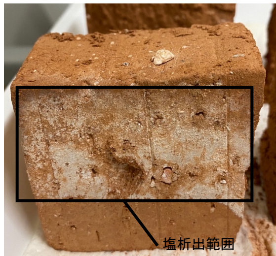
図 4.12 5V, 0.5A で通電した試験体の陰極側上部
