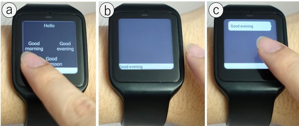
図 2.5: メッセージアプリケーション. (a) Local Functions に設定した定型文を GUI 表示. (b) B2B-Swipe による定型文の入力. (c) タップによってメッセージを送信
