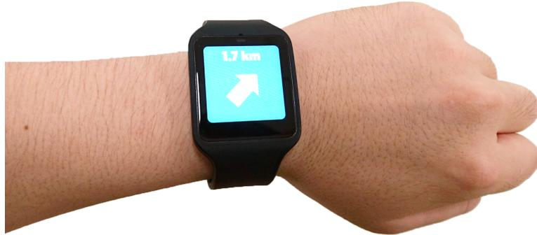
図 4.2: SynCro の使い勝手を示すためのスマートウォッチのみを用いる場合の地図アプリケーション。目的地を選択すると、スマートウォッチに目的地までの距離および方向を示す矢印が表示される。表示する情報量は必要最低限のものとするにより、歩きながらでも簡単に見ることができる
