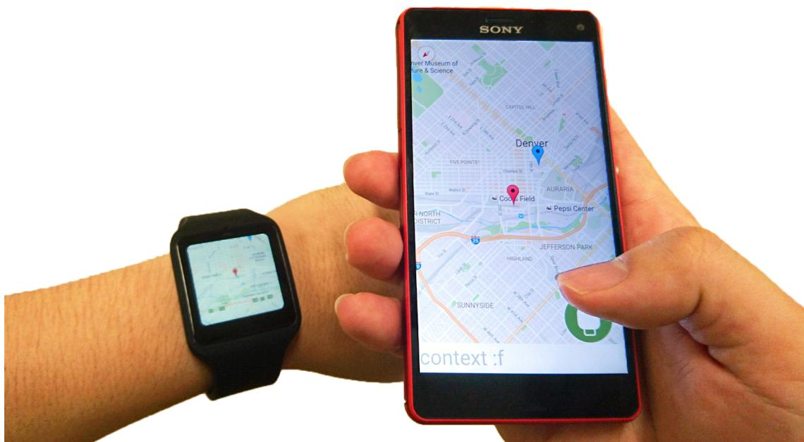
図 4.1: SynCro の使い勝手を示すための両端末を用いる地図アプリケーション. スマートフォンの広い画面を使って地図を閲覧し, 親指により目的地を選択することができる
