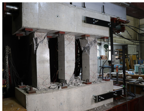
図 3 RC 柱群の加力実験
