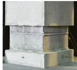
図 6 コンクリートの浮き・剥離の模擬
