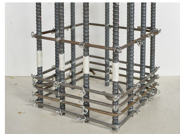
図 7 鉄筋腐食の模擬
