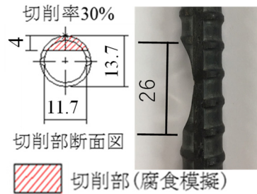
図 7 鉄筋腐食の模擬
