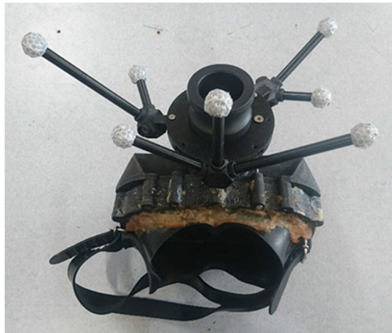
図2 頭部搭載型水中ディスプレイに設置したマーカの配置
