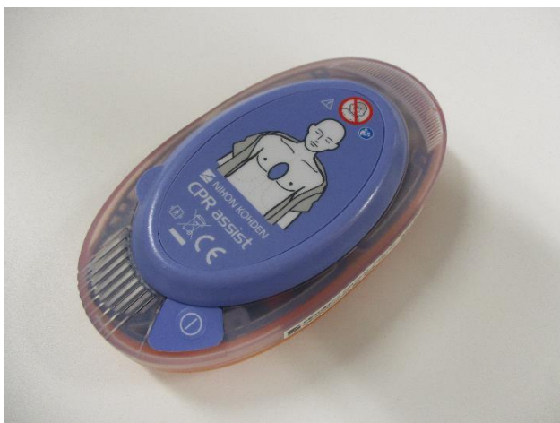
図 1: リアルタイムフィードバック装置 CPR アシスト™(CPR-1100, 日本光電, 東京都新宿区)
