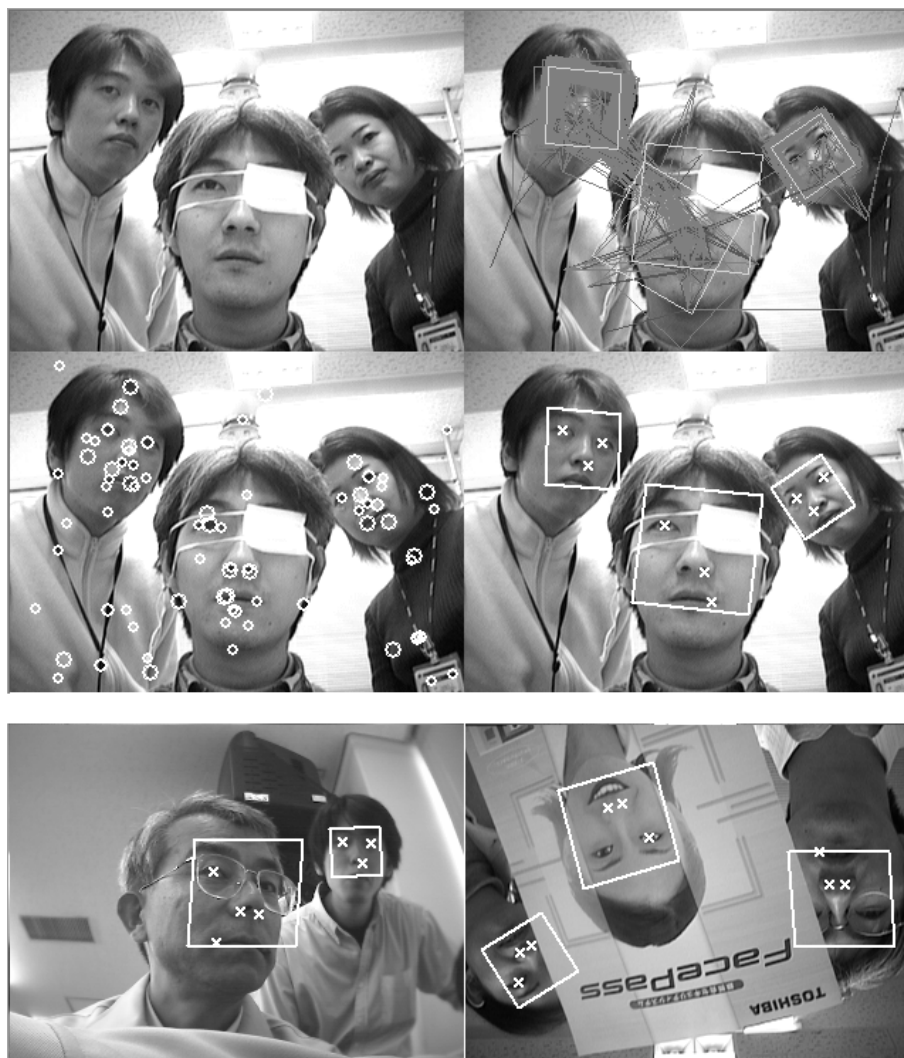
図 30: 顔認識の例. 左上: 入力画像、右上: 計算された複数の仮説、左中: 円領域検出の結果、右中: 検出された顔領域と顔特徴点、下段: その他の例
