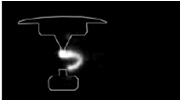
図 1-32 グロー放電中における火花の放電経路外観例 [24]
