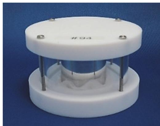
図 5-2 本研究で設計・製作した輸送容器。ポリテトラフルオロエチレン製の台座と上蓋、ガラス製の円筒、4本のねじからなる。白金イリジウム合金製キログラム仲介標準器は、台座上面の浅い窪みと上蓋に挟まれて固定される。
