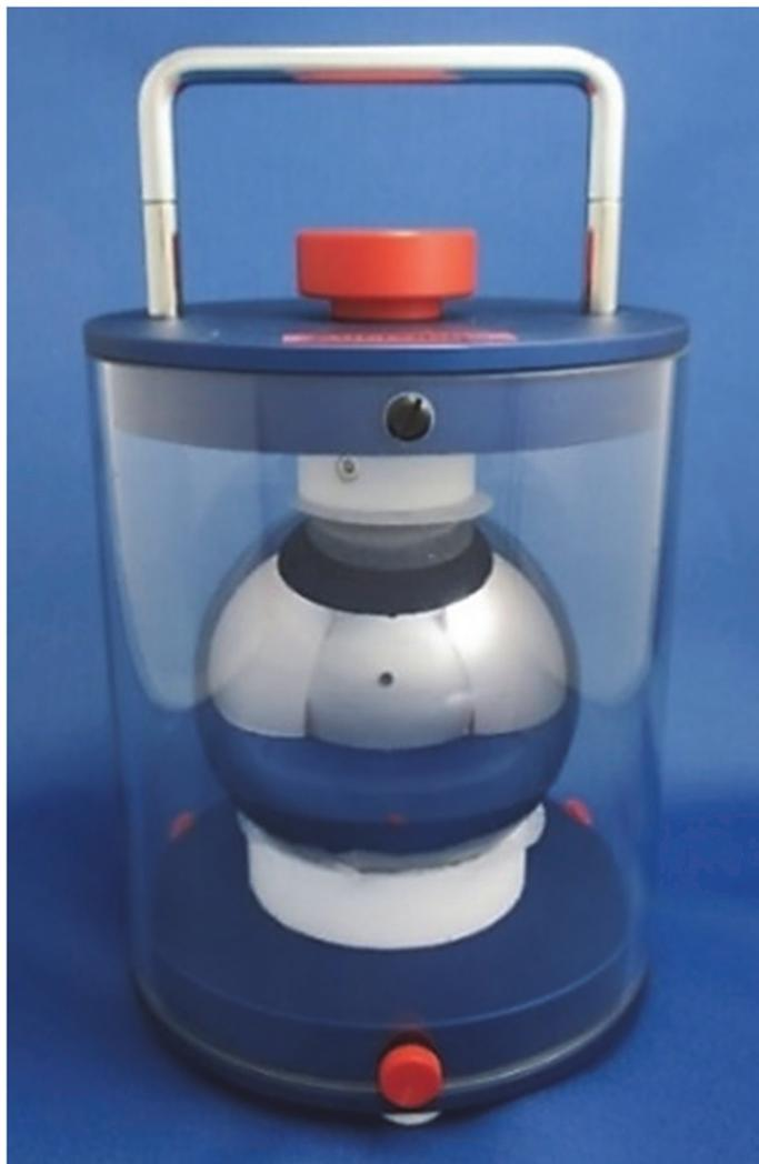
図 1-7 樹脂製容器内の直径約 93.7 mm のシリコン 28 単結晶球体。輸送の際には、樹脂製容器ごとアルミニウム合金製の箱に収められる。
