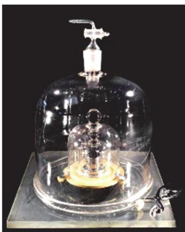
図 1-1 3重のベルジャー下の空気中に保管された国際キログラム原器（出典：国際度量衡局ウェブサイト <https://www.bipm.org/>）。1889年から2018年まで、その質量は正確に1 kgとされてきた。
