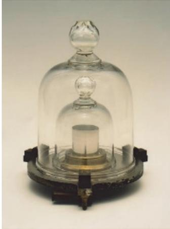
図 1-3 2重のベルジャー下の空気中に保管された日本国キログラム原器 No. 6。1991年に国際度量衡局が実施した、第3回各国キログラム原器の定期校正で決定された質量値は、 $1\text{ kg} + 0.176\text{ mg}$ である。
