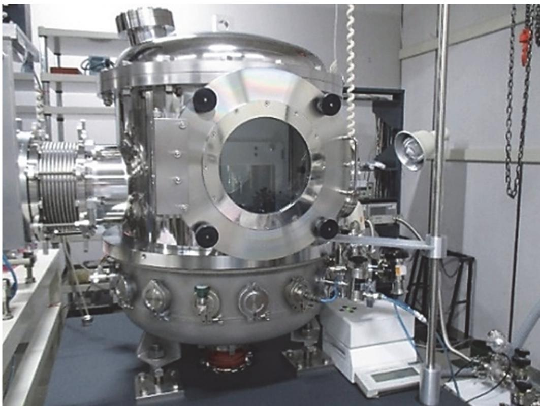
図 2-2 真空天秤の写真。手前の大型の光学窓付き扉から 1 kg 分銅を天秤内に入れることができる。
