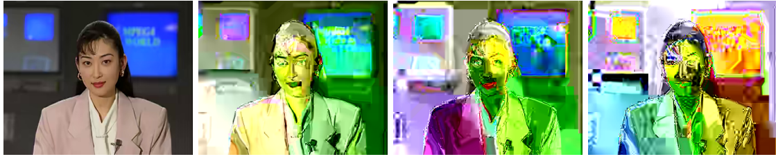
図 4.15 映像符号化 HEVC への BEESB の適用結果：(a) 元映像 Akiyo の第一復号 (I) フレーム， (b) BEESB ( \ell_{1,\dots,7}^{[2]} = 100 )，(c) BEESB ( \ell_{1,\dots,26}^{[3]} = 100 )，(d) BEESB ( \ell_{1,\dots,63}^{[2]} = 100 )．
