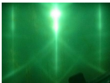
Fig. 3-1 MgO(001)基板の RHEED 像 MgO 基板に由来する 3 本の明瞭なストリークが現れている。菊池線も現れており, 基板表面の平坦性が高いことがわかる。
