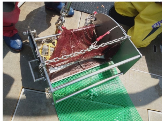
図 7. 破損した新型ドレッジ.
