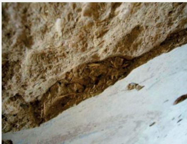
تصویر ۲.۴: لایه‌ای که با فیبر گاه فشرده شده است. احتمالاً بین سطح صخره و زمینه (مغاره I، طاقچه)،
