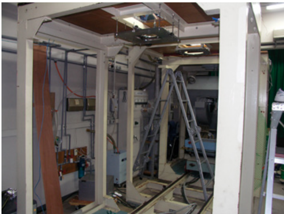
図1 3t電磁石用架台。奥に見えるのがレールの乗った3 t 電磁石とその回転台。当初は全長6 m以上、架台だけの重量1.5 tであった。その後、長さを5m、4mと短縮した。奥には磁気天秤、手前には振動試料磁束計（VSM）を設置した。
