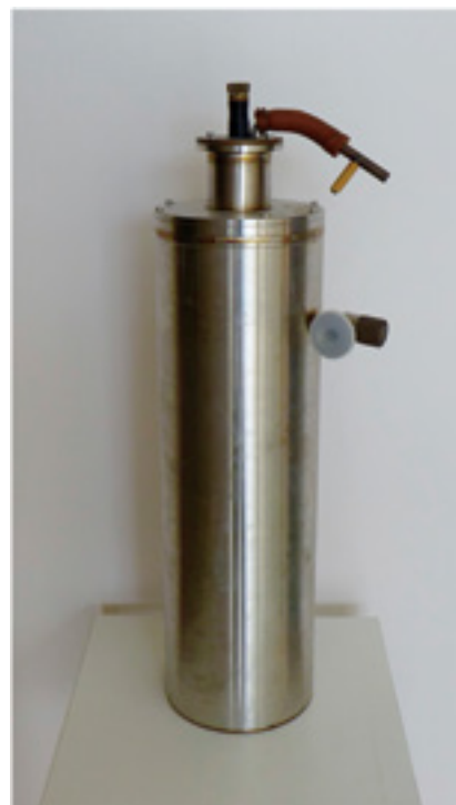
図 5 吸引式VSMクライオスタット (写真左) とHeタンク (外径160mm)
