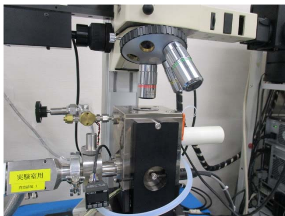
図 3 高温共焦点走査型レーザー顕微鏡。大気中 1800 ^{\circ}\text{C} までの観察が可能。
