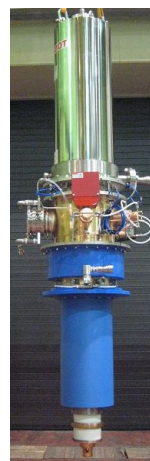
図 6 2MW ジャイロトロン写真
