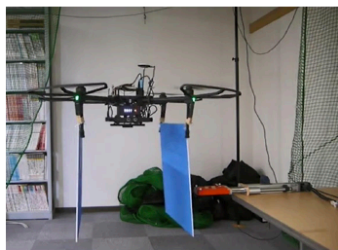
図 7 : 力覚センサを装着したリニアアクチュエータにより水平方向の提示力を計測する様子
