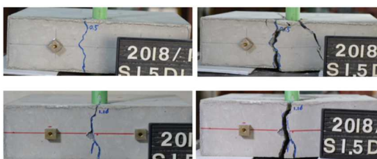
破砕剤によるひび割れ 加力終了後
