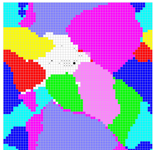
図10 コンクリート打音データの自己組織化結果
