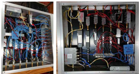
図2 製作したBPF回路（左;RF、系右;LO系）
