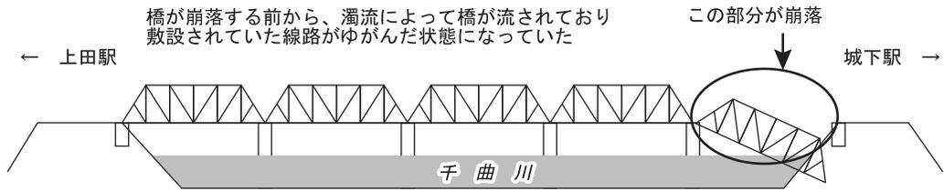
第2図 上田電鉄千曲川橋梁の模式図
