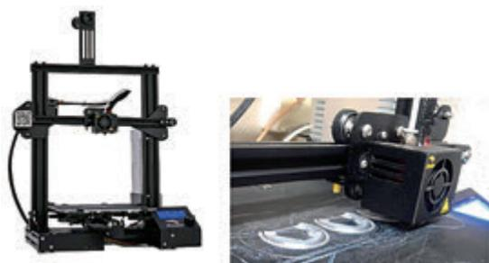
図3 3Dプリンタと積層造形の様子
