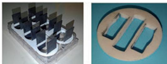
図9 炭素電極ホルダの最終製品と試作品
