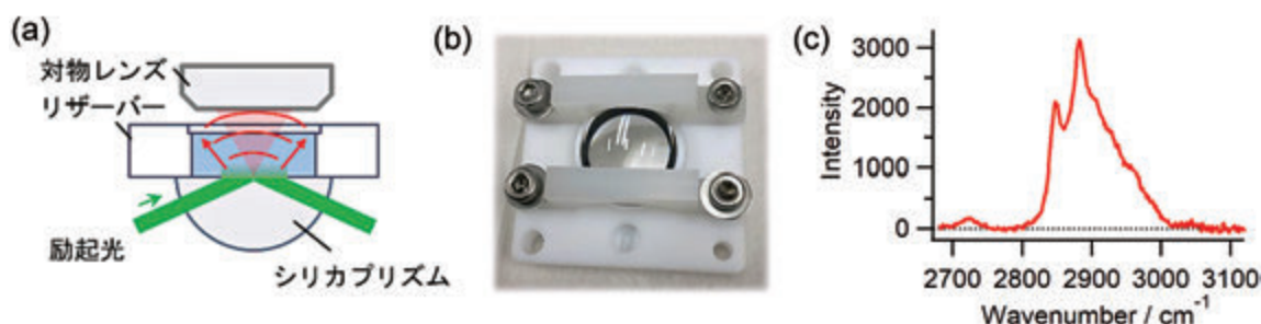
図2 (a) 試料部の概要、(b) 半球プリズムを用いたセル（第一号機）の写真、(c) 固液界面のリン脂質二重膜のラマンスペクトル
