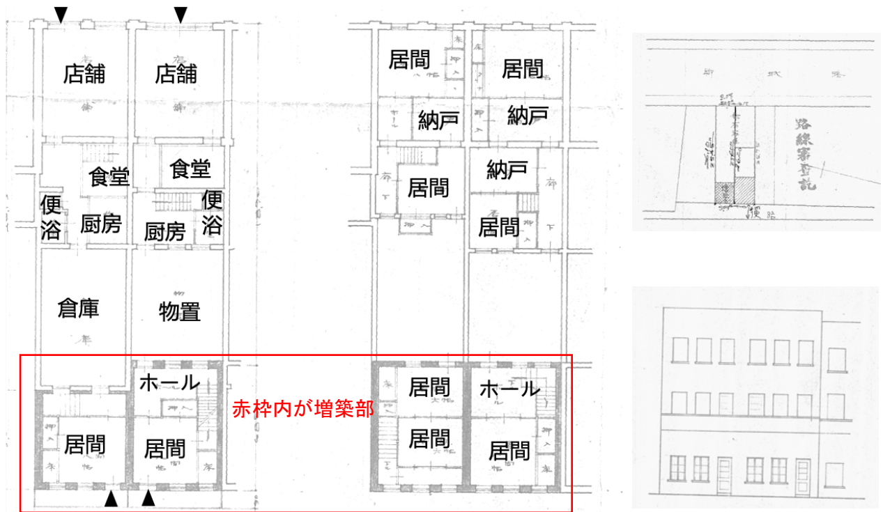
図 3-18 ㊸の一階と二階平面図、配置図（右上）、工事部立面図（右下）（「1940-0027」より）
