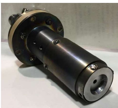
図 2-29 検証実験後のホローカソード外観
