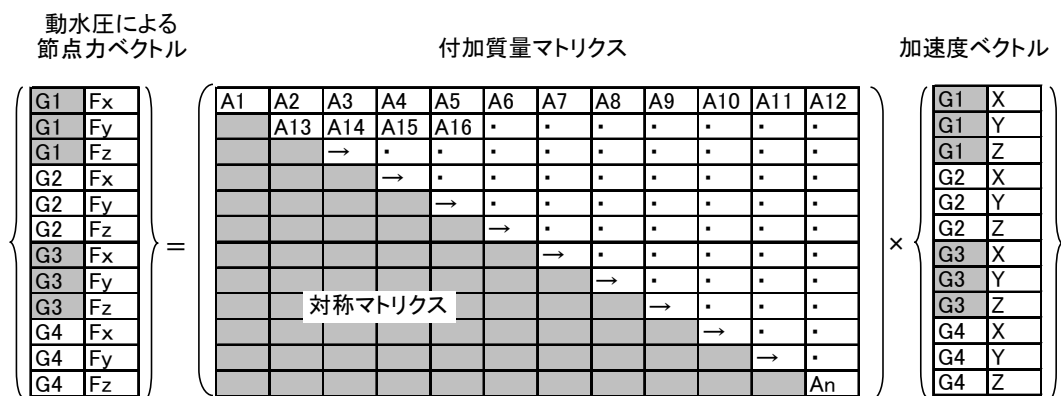
図-3.8 節点に作用する動水圧荷重の概念図 その2
