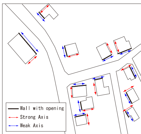
図24 建物の強軸弱軸方向の例
