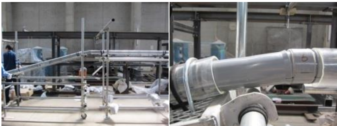
図 4-22 既設鋼管ねじ継手離脱後の地盤変状による曲げを想定した実験状況
