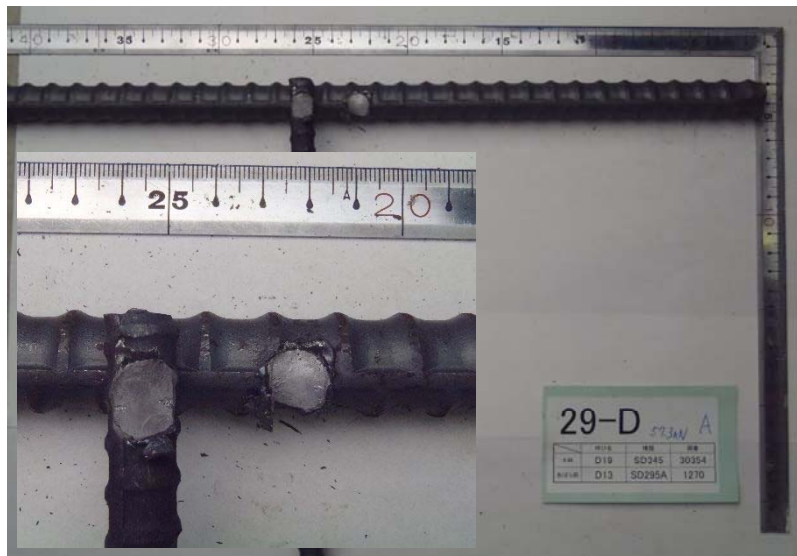
写真 3-3 母材の破断荷重近傍で溶接部剥離した試験体
