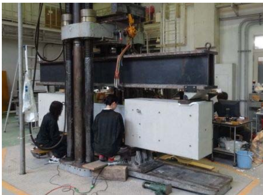
写真 4-2 シリーズ1 基礎梁実験の加力装置全景
