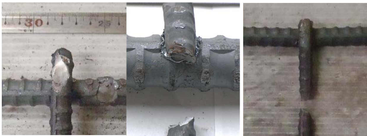
(a) 溶接部破断 (溶着金属の破断もしくは剥離)
