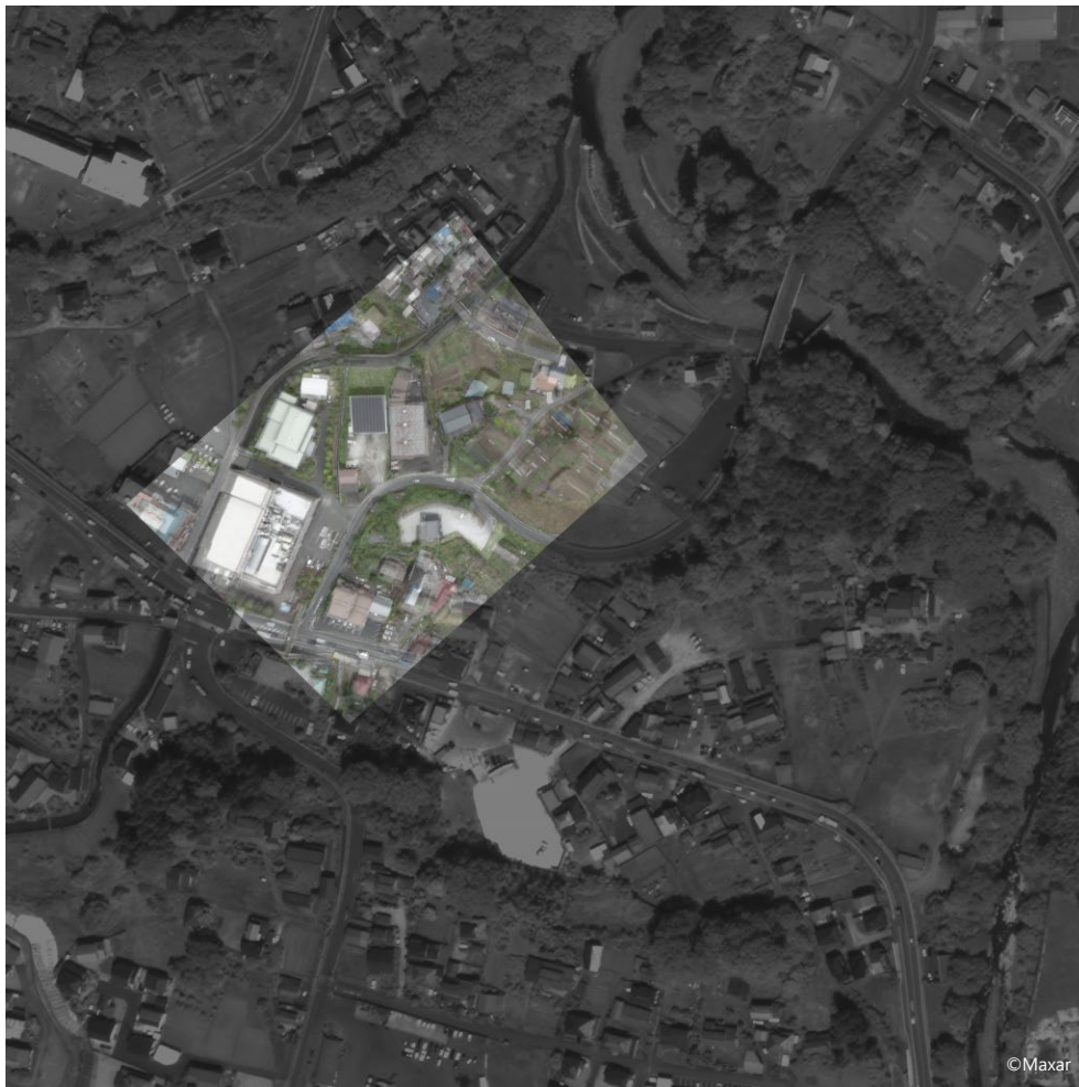
図 6-10 GeoEye-1 衛星画像と低空撮影画像の画像レジストレーション
