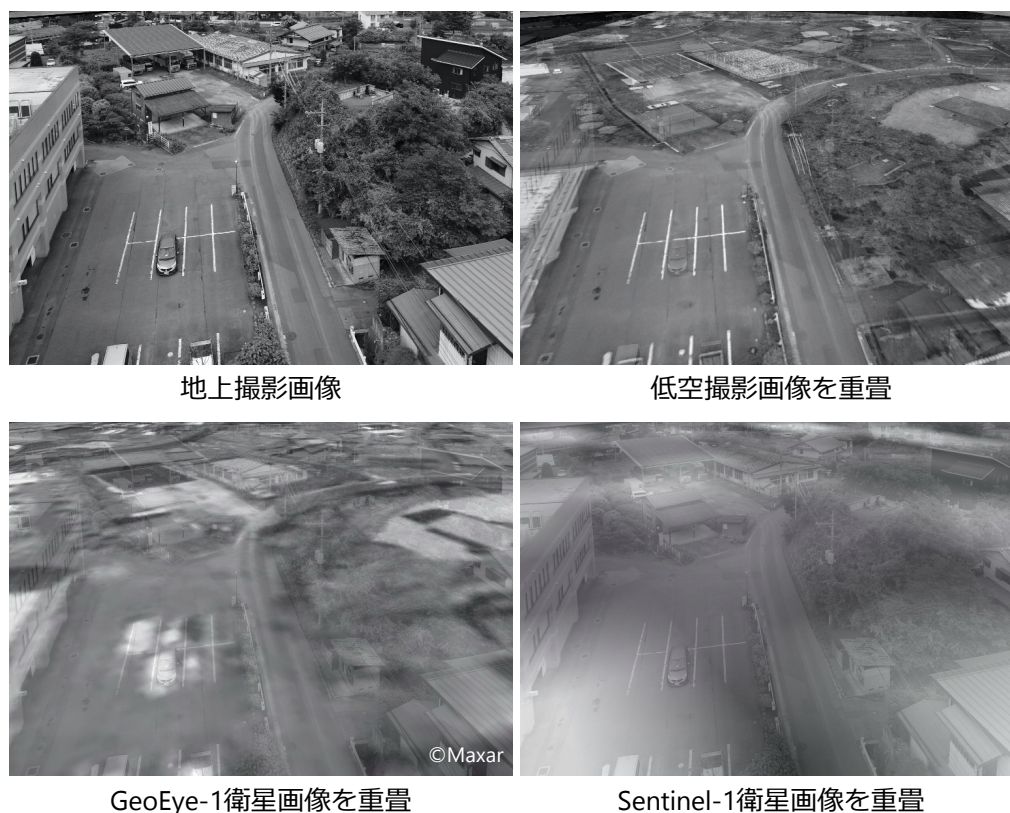
図 6-15 地上撮影視点へ画像を重畳した結果 それぞれ透明度 0.25 でオーバーレイしている。
