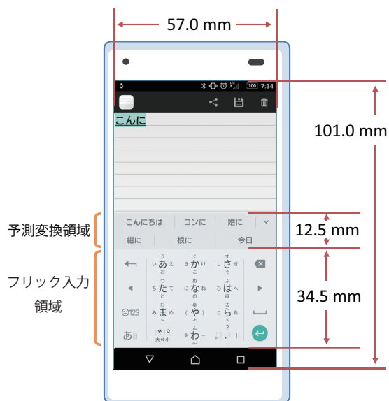
図 6.20: 実験に用いたソフトウェアキーボードのサイズ
