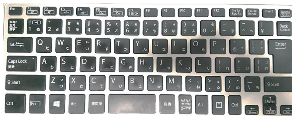
図 6.3: かな文字入力対応の QWERTY 配列フルキーボード (JIS 配列)
