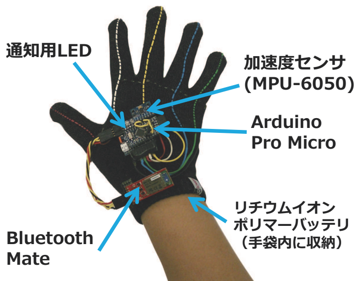
図 4.4: 指の曲げ推定用データグローブ
