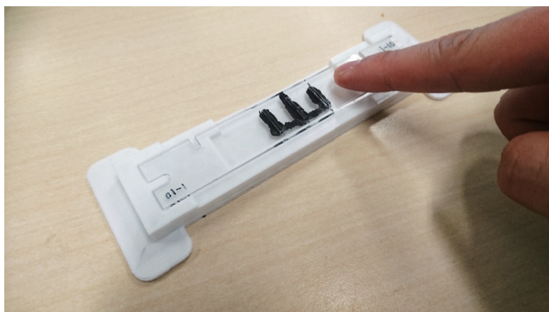
図 2.13: 電極を固定するための土台
