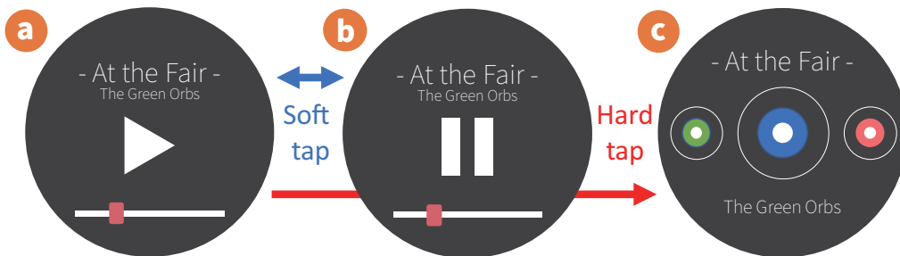
図 3.32: BaroTouch を用いた音楽プレイヤー (a: 再生モード, b: 一時停止モード, c: 楽曲リスト)
