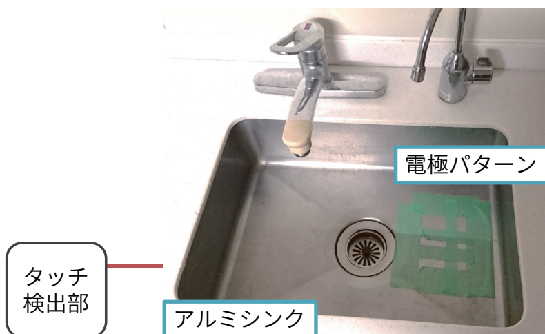
図 2.24: アルミシンクをタッチインターフェース化した例
