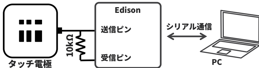
図 2.12: 評価実験 2 の認識システムの構成
