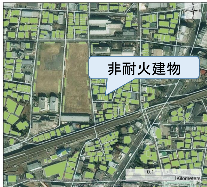
図 4-3 実市街地における通行不能領域の生成例：非耐火造建物の選択
