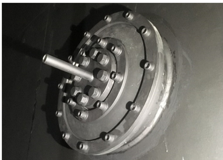
図 4-3 ノズル試験体設置部の写真
