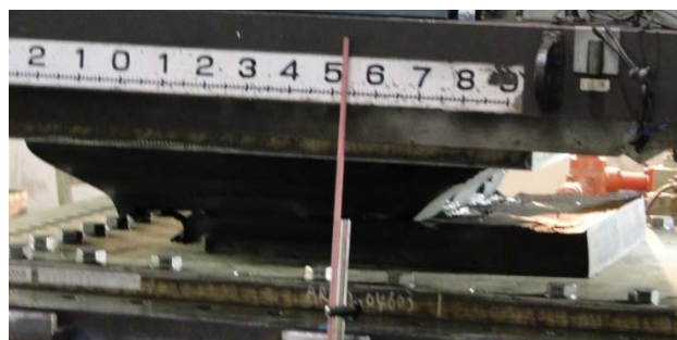
写真-4.4 ゴム支承の水平載荷実験(ゴム支承破断時)
