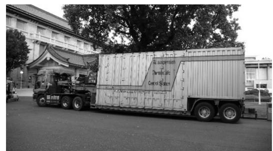
Fig. 1-2-30 大型の文化財を輸送する際に用いられる低床エアサストレーラー
