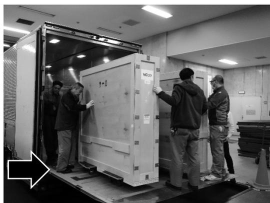
Fig. 1-2-26 貨物をリフトするために後部に取り付けられたパワーゲート（矢印）
