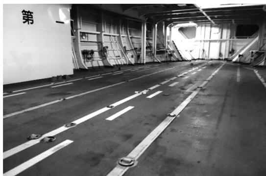
Fig. 5-3-30 床面には車両固定用の金具が
