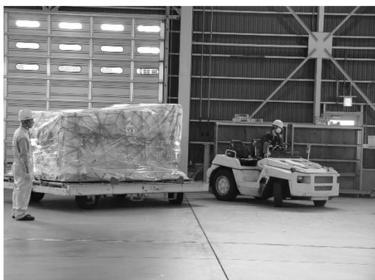
Fig. 1-2-35 パレットを航空機下まで牽引するドーリー
