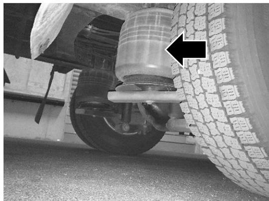
Fig. 1-2-22 美専車に取り付けられたエアサスペンション（矢印）
