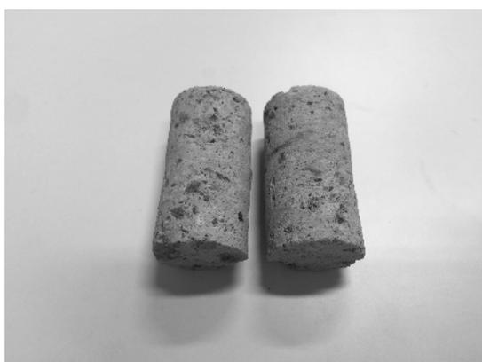
Fig. 8-2-4 凝灰岩供試体
