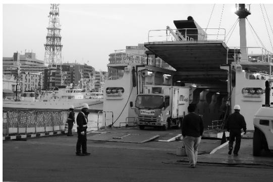
Fig. 1-2-31 トラックに積載した状態で乗船する形式の RO/RO 船
