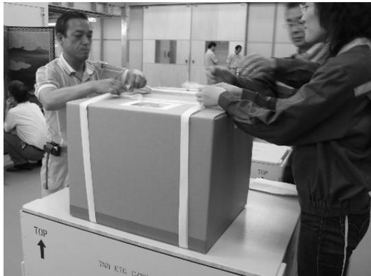
Fig. 1-2-13 ダンボール製の内箱を組み立てる
