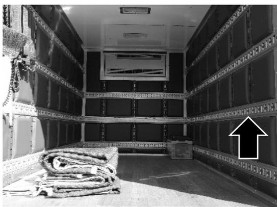
Fig. 1-2-25 荷室内の各所へラッシングベルト固定用金具（矢印）が装備されている
