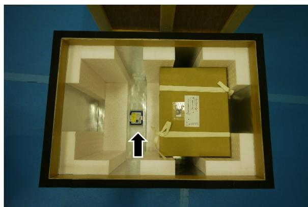
Fig. 2-1-3 梱包箱底面に設置した加速度データロガー
