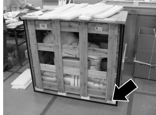
Fig. 7-2-4 外箱と内箱（木枠）との間に設置されたポリエチレンフォーム
