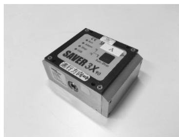
Fig. 3-1-1 加速度データロガー
