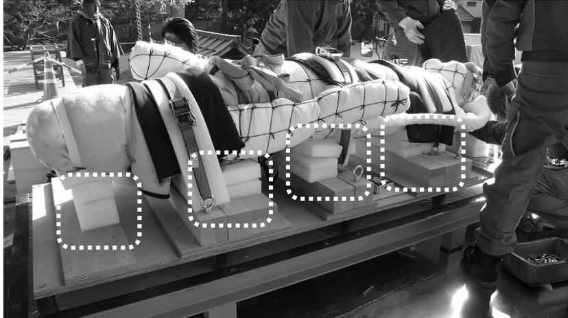
Fig. 1-2-37 文化財の表面を保護する技術や文化財の取り扱い技術についてはほぼ確立されている。一方で図中の点線枠のような輸送機関との間の緩衝設計については未だ科学的なアプローチで改善できる余地を有する。例えば、使用する緩衝材の種類と厚みによって文化財の荷重を受ける面積の最適化等は科学的な試験データに基づいて導き出すといった仕様が必要である。
