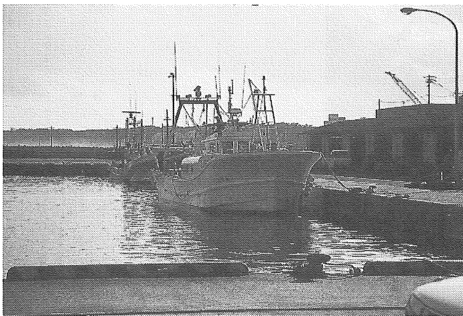
写真11 那珂湊漁港に停泊する高度專業型漁業者の漁船 15トン弱で那珂湊漁業協同組合所属船の中でも最大級である。船尾の門形クレーンは板びき網漁船の一特徴である。右手には漁具を補修する共同作業場が見える。 (1998年 日野撮影)
