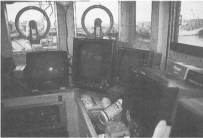
写真10 高度專業型漁業者の漁船内部 操舵室より船首方向を望む。操舵室内には魚群探知機やレーダー、GPSなど様々な機器が並んでいる。 (1998年 日野撮影)
