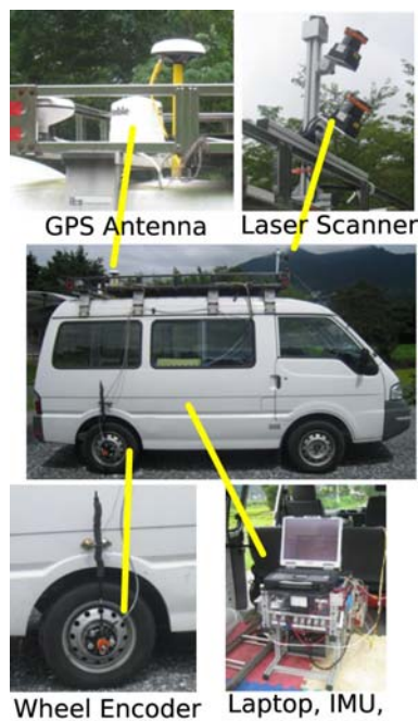
図 6 計測装置の車上配置
