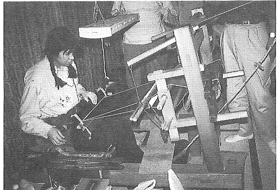
写真6 機織り(結城市小塙) 末端部を身体で固定し経糸に張力を与える。 (1994年5月撮影)
