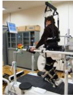
図 1 動力型歩行補助装置(Lokomat ® )
