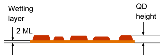
図1 ディスク状量子ドットの断面模式図。
