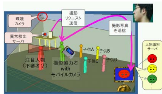
図 3：環境カメラとモバイルカメラを補完的に利用した映像監視方式
