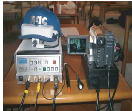
図2 アイ・トラッカー装置:ナックイメージテクノロジ株式会社のアイ・トラッカー EMR-8B (Eye Make Recorder) 眼球運動計測装置、検出レート: 60HZ(片目)、検出分解能: 眼球運動 0.1angle、瞳孔径 0.02mm、ヘッドユニット重量: 約 250g、アイマークレコーダは視野映像にデータコードを重ねたビデオ信号を出力する。
