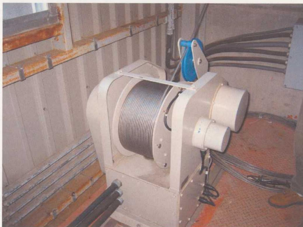
写真 C-4. ウィンチ巻き取り装置
