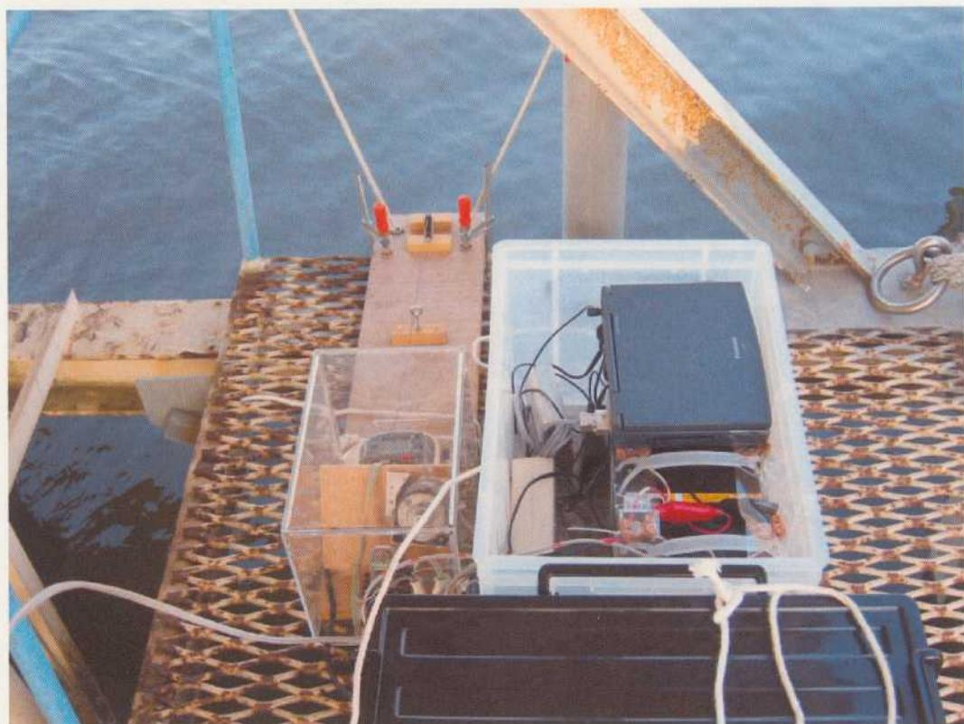
写真 A-1. センサーを上下させる装置
