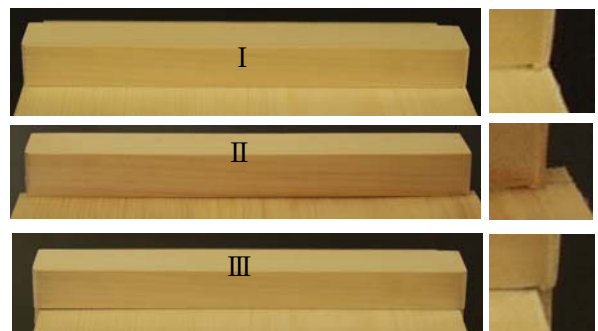
図 7. 足付きまな板の膨潤と収縮 I : 気乾、 II : 水着け、 III : 乾燥
