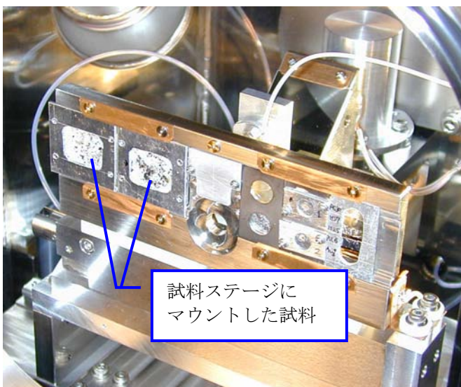
図 1 3. 水素濃度分析のためにマウントした元安橋の薄片試料を含むチャンバー内試料ステージ
