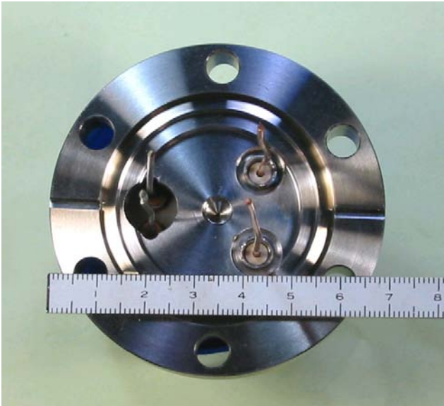
図 5. 真空側から見た ICF70
