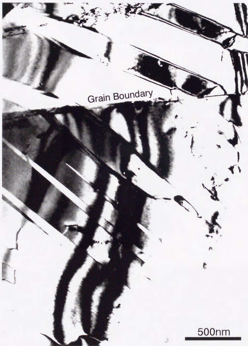
図 2-1 Ti-47.75Ni-1.50Fe(at.%)におけるR相の形態の電顕観察例. R相は互いに複合双晶の関係にあるバリエントがバンド状に並び, 自己調整を行っている. 各バリエントは粒界を挟んでも繋がっているように見える.
